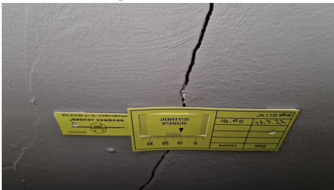
Figure 14 : Instrumentation mise en œuvre
