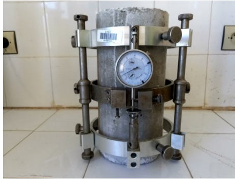
Figure 3 : extensomètre pour la mesure de la déformation verticale
