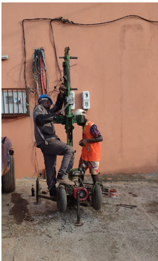
Figure 7 : Exécution des sondages au pénétromètre dynamique
