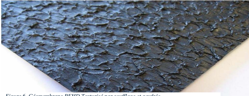
Figure 6. Géomembrane PEHD Texturisé par soufflage et gaufrée
