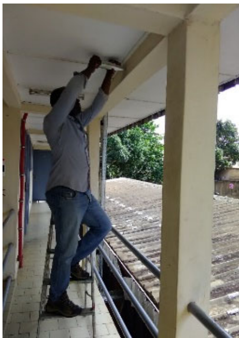
Figure 10 : réalisation des essais sclérométriques
