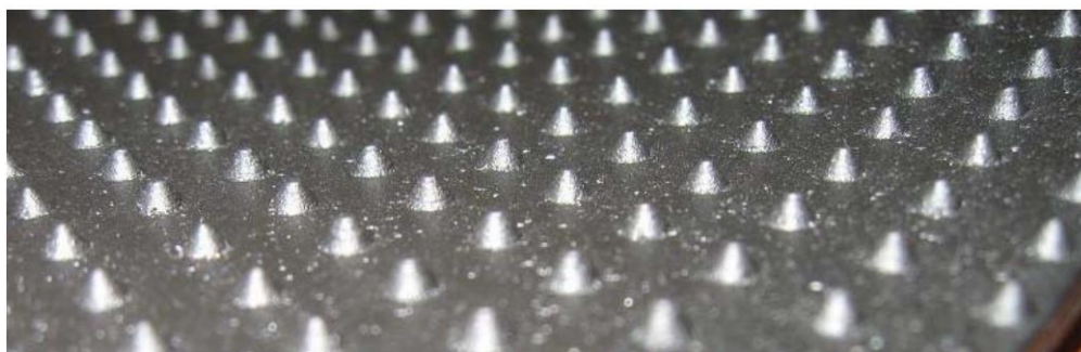
Figure 4. Géomembrane PEHD Alvatech Fix. Structuré par Calandrage. Texture homogène.
