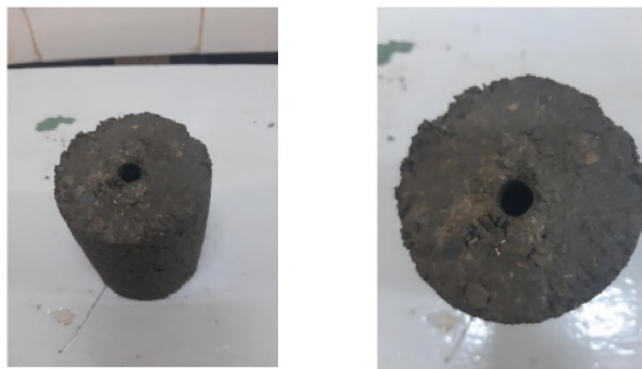
Figure 10 : Photos d'éprouvettes soumises à l'essai Pinhole test
