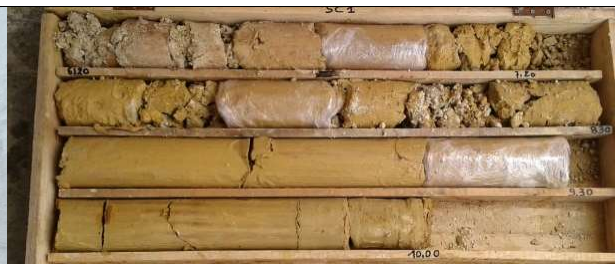
Sondage montrant des travertins en excavation et marnes jaunâtres en fond de fouille
