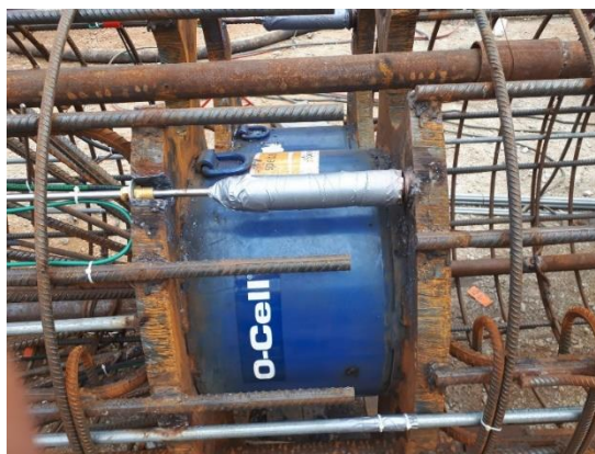
Figure 6. Vue d'une cellule d'Osterberg
