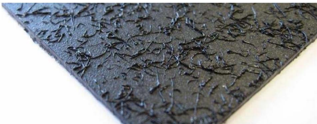
Figure 5. Géomembrane PEHD Texturisée par projection. Texture hétérogène.
